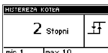
Этот режим служит для установки гистерезиса заданной температуры Ц.О. Это разница между температурой входа в цикл поддержки и температурой возврата в рабочий цикл (напр. когда заданная температура установлена на 60°C, а гистерезис составляет 3°C, переход в цикл поддержки наступит после достижения температуры 60°C, а возврат в цикл работы наступит после понижения температуры до 57°C).
