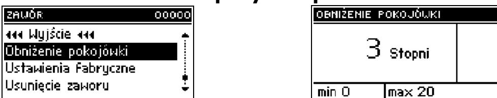
Эта функция активна только при совместной работе контроллера с комнатным двухуровневым регулятором (стандартным). Когда комнатный регулятор достигнет заданную температуру в квартире (определит разогрев), клапан прикроется так, чтобы температура за клапаном понизилась на температуру <понижение комнатного регулятора>.
