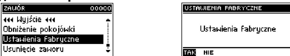
Этот параметр позволяет вернуться к настройкам данного клапана, установленным производителем. Возврат заводских настроек не изменяет установленного типа клапана (Ц.О. или напольный).
