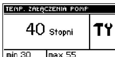
Эта функция служит для настройки температуры включения насоса ц.о. и насоса гор. воды (это температура, измеряемая на котле). Ниже этой температуры оба насоса не работают, а после достижения температуры включения насосы активны и работают в зависимости от режима работы (см.: режимы работы насосов).
