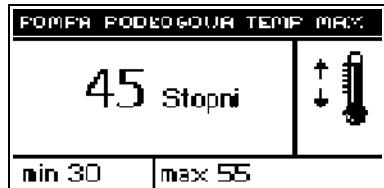
Эта функция служит для управления напольным насосом. Пользователь задает температуру напольного отопления в диапазоне 30°C – 55°C. После активации (включения) напольного насоса, следует настроить минимальную (пороговую) температуру включения насоса (измеряемую на котле) и максимальную (заданную) температуру напольного отопления (измеряемую на напольном датчике насоса).
