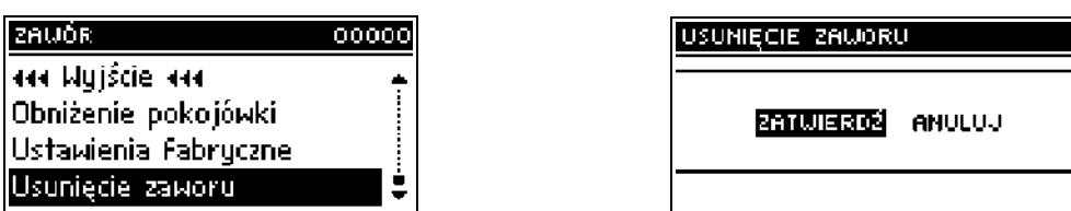
Эта функция служит для полного удаления клапана из памяти контроллера. Удаление клапана используется напр., при демонтаже клапана или замене модуля (необходима повторная регистрация нового модуля).
