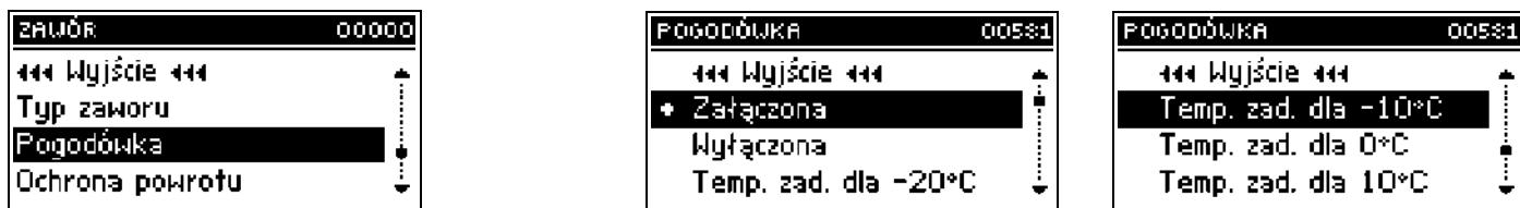
Чтобы функция погоды была активной, следует поместить наружный датчик в месте, не подверженном солнечным лучам и атмосферным факторам. После установки и подключения датчика, следует включить функцию *Погодное управление* в меню контроллера.
