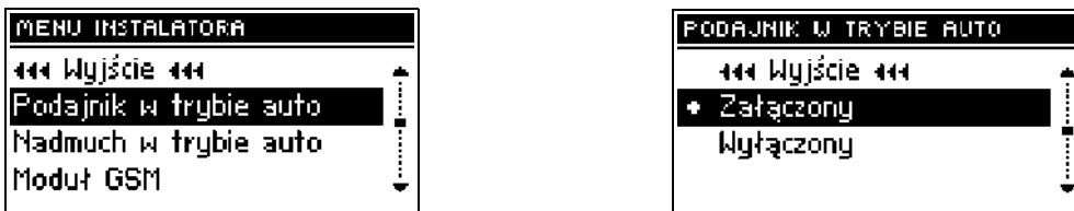
Это возможность включения или выключения автоматической работы подавателя. Подаватель можно выключить для ручной подачи топлива или для того, чтобы вызвать погашение котла.
