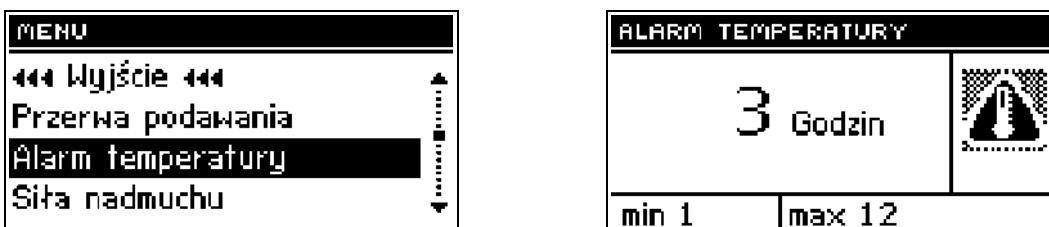
Эта функция включается только в режиме **работы** (если температура котла ниже заданной температуры). Если температура котла не растет в течение определенного пользователем времени, срабатывает сигнализация: Выключается подаватель и наддув (насос воды включается и выключается независимо) и включается звуковой сигнал. На индикаторе показывается сообщение: „**Температура Ц.О. не растет**“. Сигнализация сбрасывается при нажатии на импульсатор.
