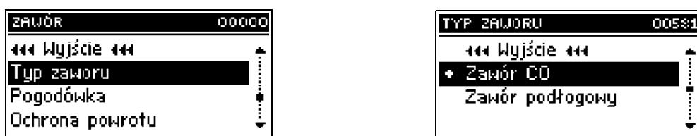
При помощи этой функции пользователь выбирает вид применяемого клапана: Ц.О. или напольный.
