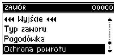
Эта функция позволяет настроить защиту котла от слишком холодной воды, возвращающейся из главной циркуляции, которая могла бы быть причиной низкотемпературной коррозии котла. Защита возврата действует таким образом, что когда температура слишком низкая, клапан прикрывается до времени, пока короткий цикл снова не достигнет соответствующей температуры. Эта функция защищает также котел от опасной высокой температуры возврата, чтобы вода не закипела.
